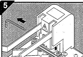
輕壓下把手，將一字型六角板手取出，放開把手，即完成換刀及校正側板工作。
