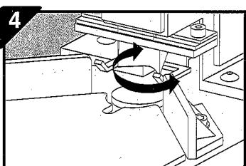
機台應隨時裝有塑膠墊，以保護刀具之刀口，為增加塑膠墊使用次數，所以當塑膠墊被刀具切割到無法再切斷紙張時，請用一字型六角扳手輕輕的旋轉塑膠墊（如圖示方向），換個新位置就可再使用。
